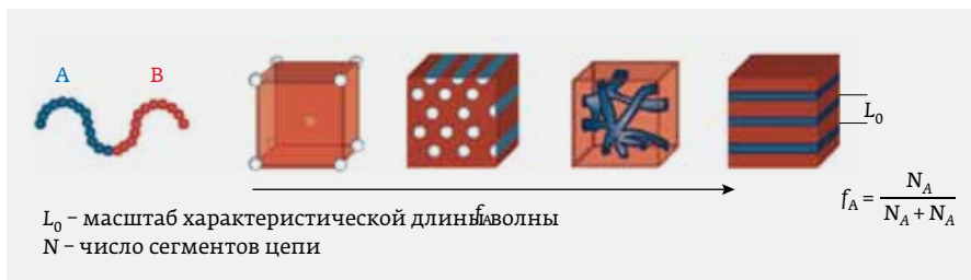
Рис. 6. Морфология типичного блок-сополимера как функция (химического) состава. По мере возрастания доли компонента А конфигурация изменяется от сферической к цилиндрической и далее к пластинчатой
