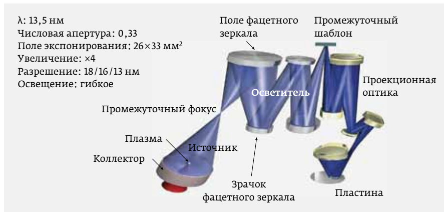
Рис. 2. Основа EUV-литографии – использование отраженного оптического излучения. Источник: ASML/ Carl Zeiss
