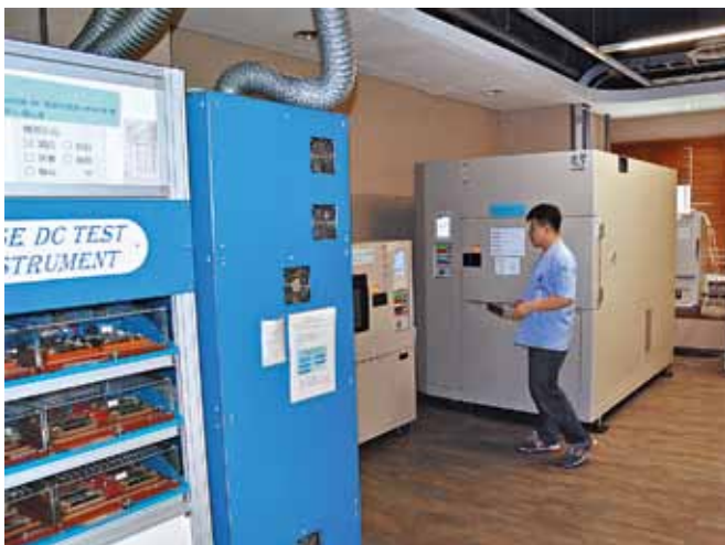
Испытательные установки. Слева на переднем плане – установка циклических испытаний на подачу-снятие нагрузки
