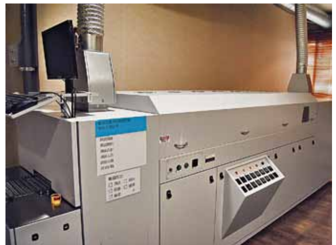
Печь конвекционной пайки оплавлением, используемая для испытания на качество пайки предохранителей для поверхностного монтажа
