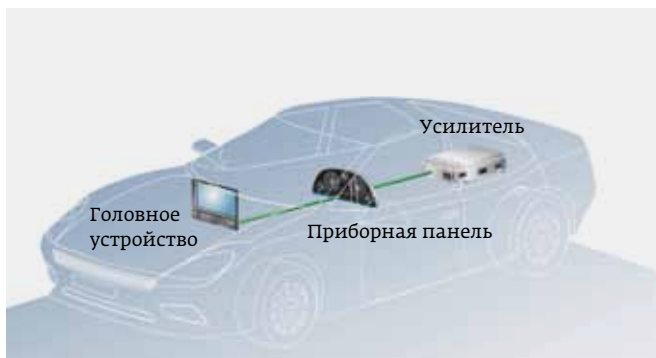
Рис. 4. Информационно-развлекательная система, состоящая из трех узлов, включенных по топологии «цепочка» на основе коаксиального физического уровня с использованием FD-связи
