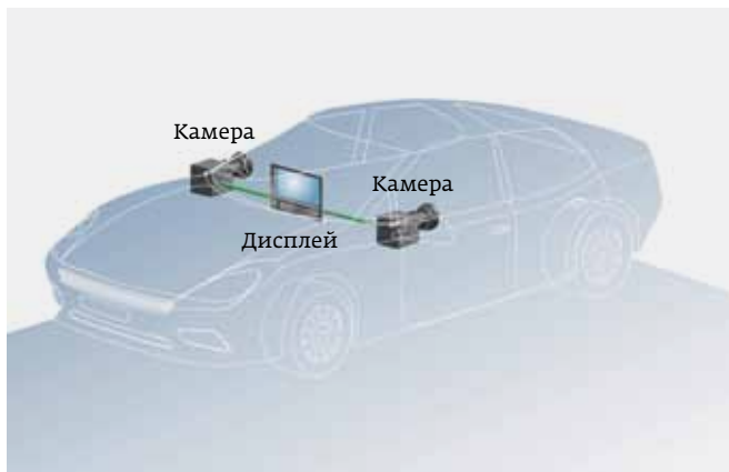
Рис. 5. Конфигурация типа хаба на основе коаксиального физического уровня с использованием FD-связи
