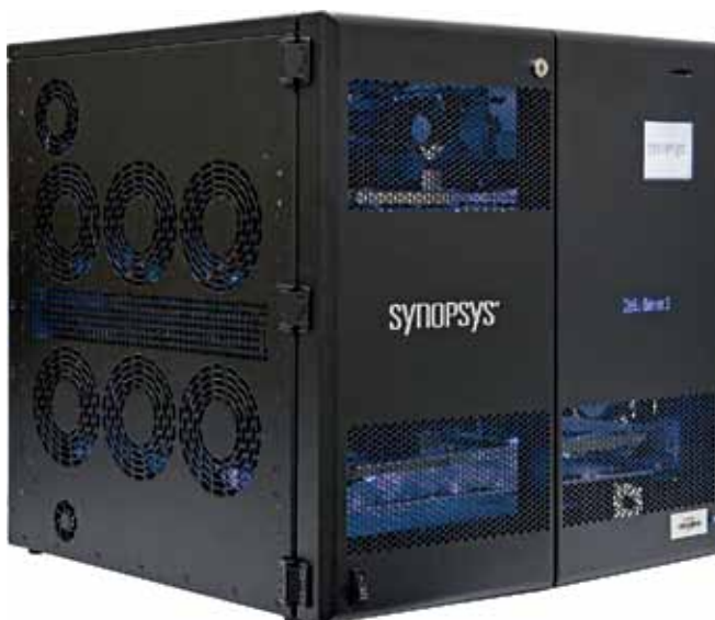
Рис. 8. Эмулятор Synopsys ZeVu
