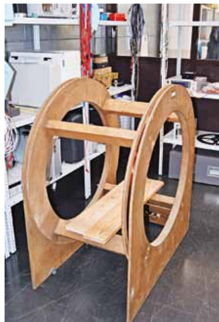
Кольца Гельмгольца в установке для испытаний на устойчивость к воздействию постоянного и переменного магнитных полей
