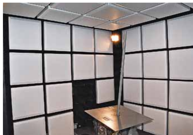
Внутреннее пространство полубезэховой камеры. Под белыми панелями находится радиопоглощающий материал
