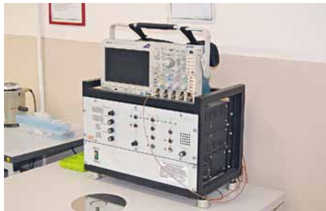
Установка определения наличия посторонних частиц в корпусе компонента
