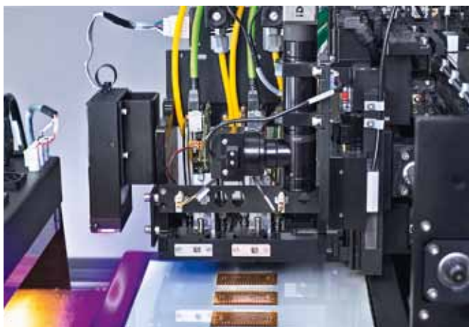
Рис. 2. Рабочая зона 3D-принтера DragonFly
