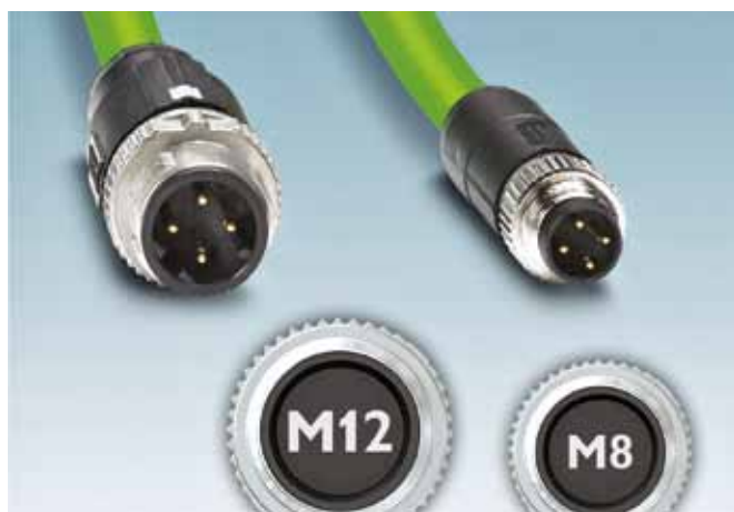
Рис. 1. Миниатюризация кабельных разъемов: типоразмер M8 занимает на треть меньше места, чем M12
