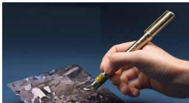
**Рис. 2.** Прибор PN-100 для бесконтактного определения типа проводимости кремниевых слитков и пластин
