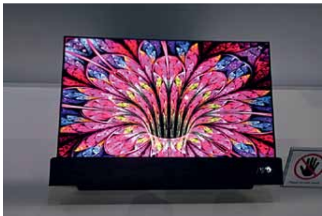
Рис. 1. ЖК-дисплей с мини-светодиодной подсветкой (Mini-LED), яркость 700 нит (700 nits), контраст 1000 000 : 1, 6720 мини-светодиодных зон
