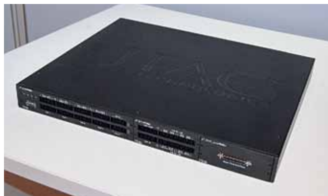
Одно из решений, представленных на стенде JTAG Technologies, – модульный тестер-программатор в шасси JT 57xx/RM1c в формфакторе 1U
