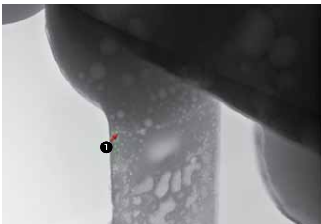
Рис. 2. Рентгеновский снимок трещины в проводнике на печатной плате
