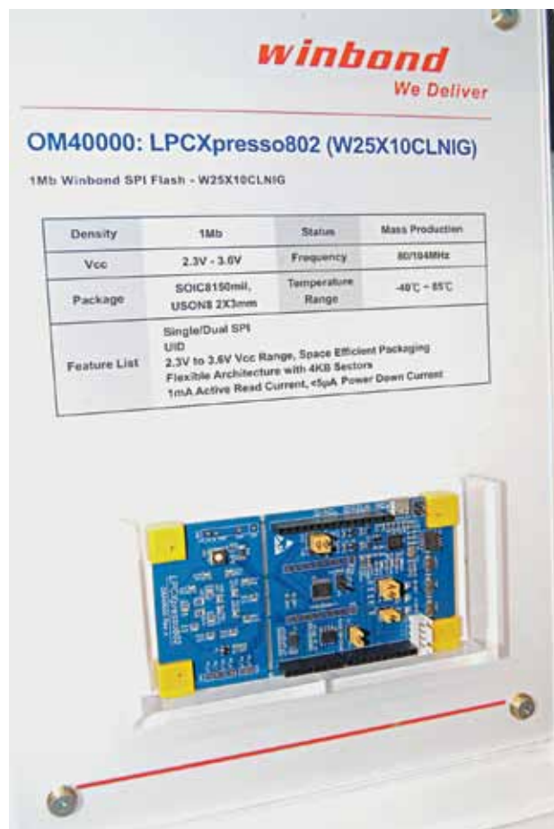
Оценочная плата LPCXpresso802 от компании NXP для микроконтроллеров семейства LPC802
