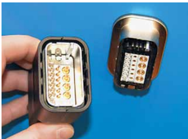
Разъем PUSH-LOCK серии ODU-MAC® Blue-Line
