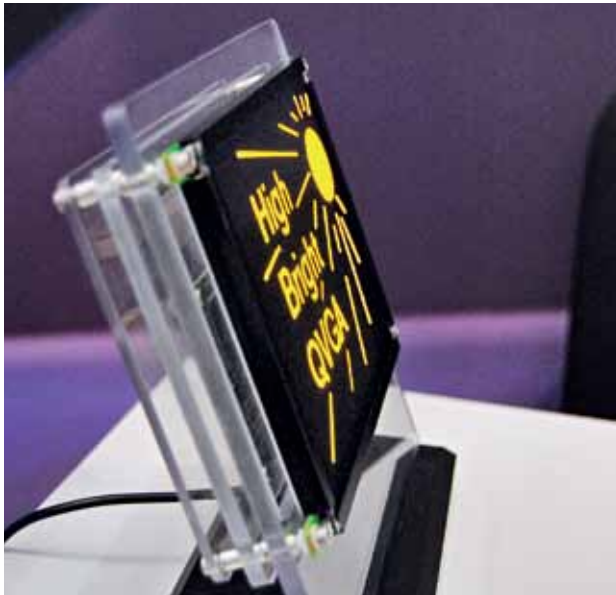
TFEL-дисплей повышенной прочности – четкое изображение при наблюдении под большим углом
