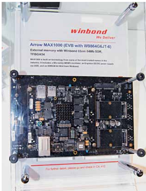
Плата разработчика Arrow MAX1000 с 64-Мбит SDRAM от Winbond
