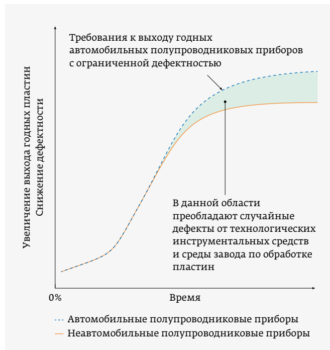
Рис. 4. Сопоставление роста выхода годных заводов по производству автомобильных и неавтомобильных полупроводниковых приборов
