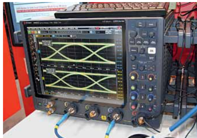
Отображение глазковых диаграмм на осциллографе реального времени Infiniium UXR0334A
