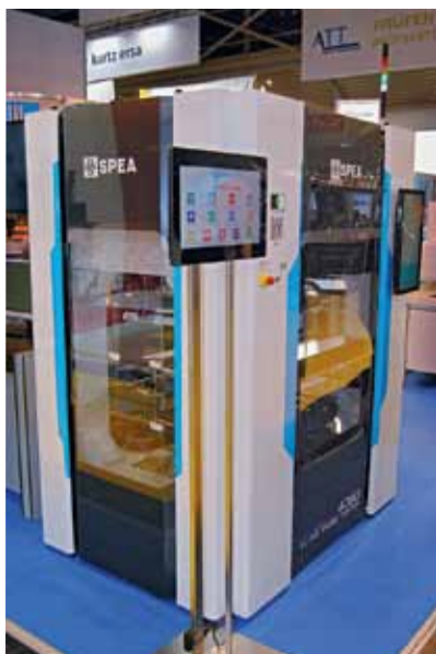
Высокоточная установка электрического тестирования с двусторонним доступом SPEA 4080. Справа – верхняя часть рабочей зоны с измерительной головкой
