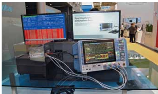
Измерение параметров сигналов модуля DDR с помощью осциллографа R&S RTP
