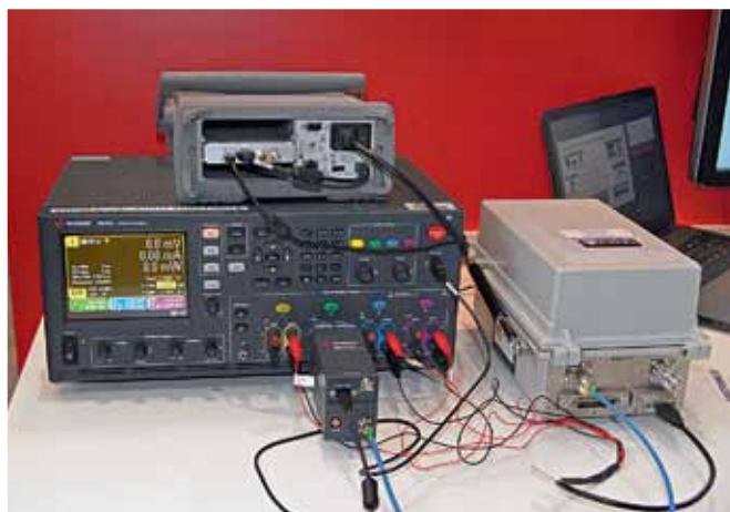
Установка для оптимизации времени работы от аккумулятора устройств Интернета вещей. Слева внизу – анализатор питания постоянного тока N6705C с подключенным к нему детектором РЧ-событий X8712AD. Справа в белом боксе – испытываемое устройство
