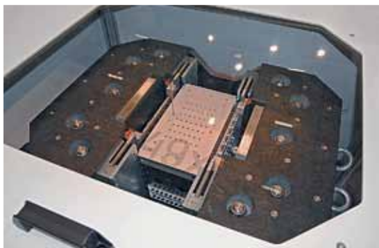
Установка для виброклиматических испытаний Shaker Test Unit. Справа – рабочая зона установки закрыта защитными конструкциями
