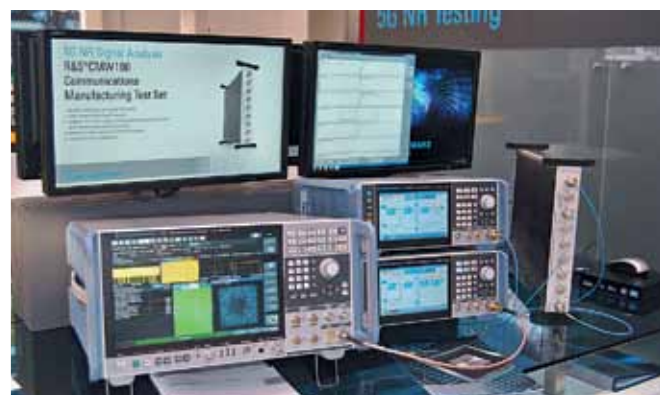
Установка анализа сигналов 5G NR. Слева направо: анализатор спектра и сигналов R&S FSW26, векторные генераторы сигналов R&S SMBV100B, производственный испытательный комплект для устройств связи R&S CMW100
