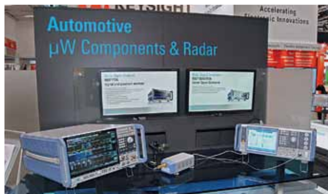
Установка исследования сигналов автомобильных радаров на основе анализатора спектра и сигналов R&S FSW85 и генератора сигналов R&S SMW200A
