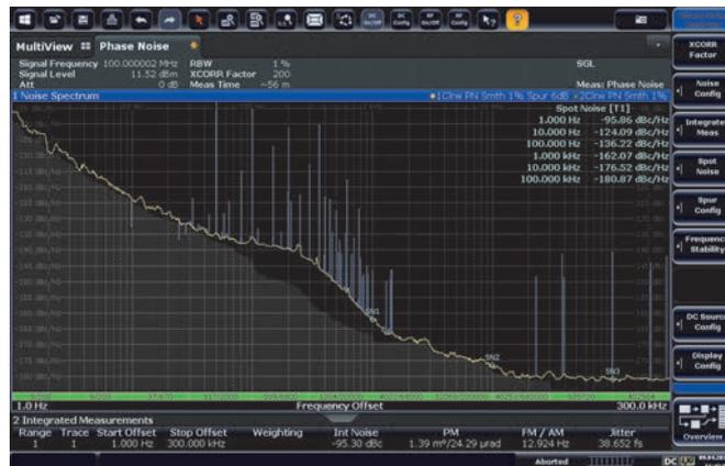
Рис. 2. Осциллограмма фазовых шумов ГК359-ТС
