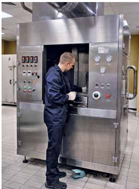
Установка горячего лужения (справа) и линия подготовки к нему
