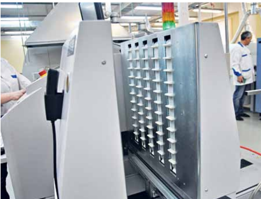
"Интерьер" транспортной системы разбраковщика (слева). Рабочие места ручной пайки (справа)
