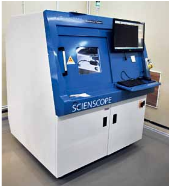
Установка рентгеновского контроля X-score 3000 фирмы Scienscope
