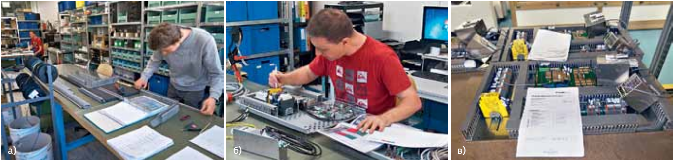
Сборка электронных модулей – монтажа кабель-каналов (а), самопроверка (б), готовые модули после тестов (в)
