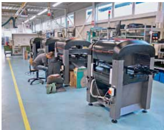
Линия сборки малых установочных автоматов Pantera
