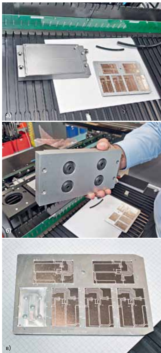
Вакуумный держатель с нагревателем (а, б) для монтажа на керамические платы (с)
