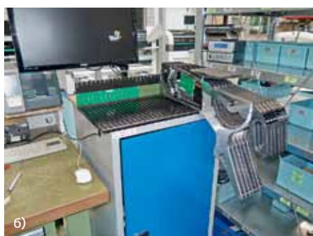
Участок сборки и контроля питателей (а). Питатели на проверочной станции (б). Стенд контроля точности подачи компонентов (в-г)
