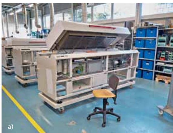
Линия сборки печей оплавления – конвейерных (а) и настольных (б)
