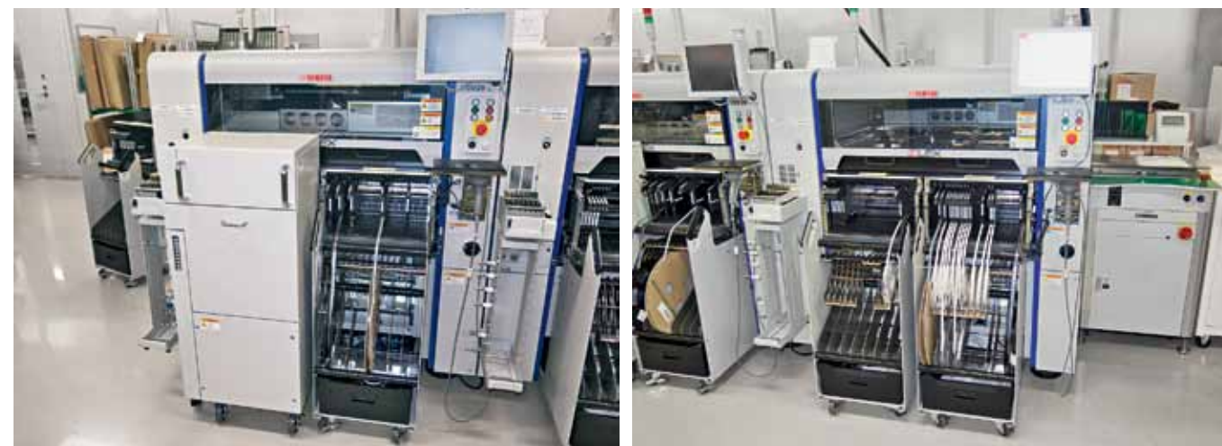
Модульный автомат установки компонентов YSM20: с питателями из паллет и с катушек (слева), только с катушек (справа)
