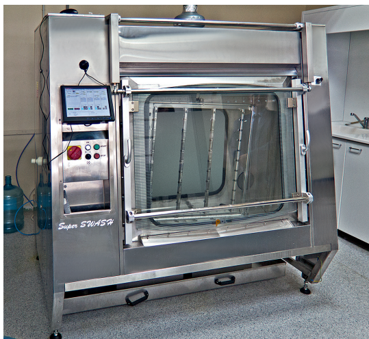
Установка струйной отмывки Super SWASH
