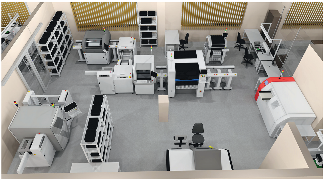
Макет участка поверхностного монтажа. От принтера Horizon 03iX (в левом дальнем углу) поворотный конвейер направляет платы в загрузчик перед автоматом дозирования Axiom X1010 и автоматом установки Samsung SM482
