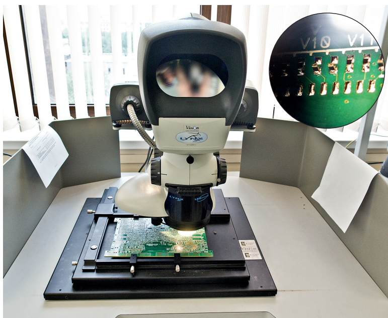
Оптический инспекционный микроскоп Luph. Виден дефект монтажа типа "надгробный камень"
