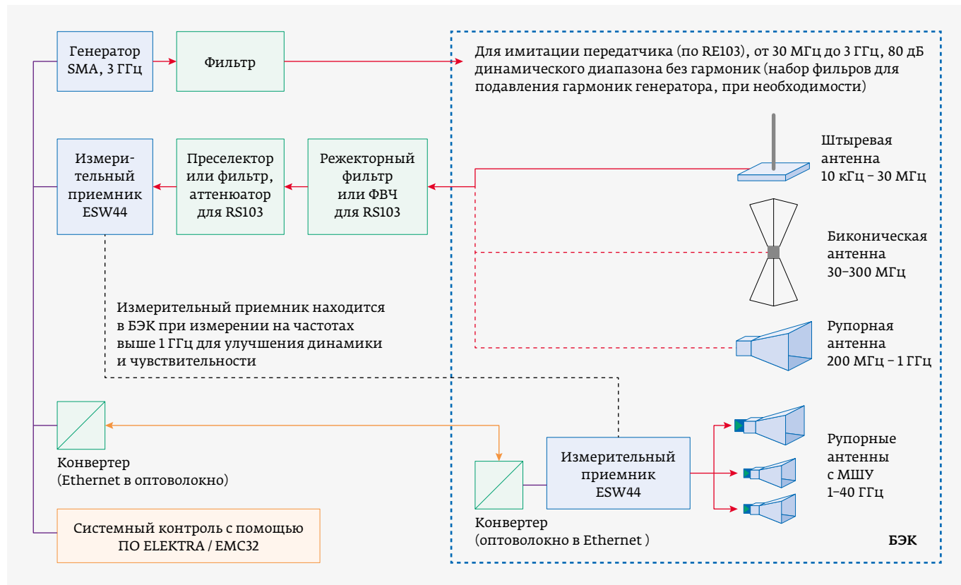
Рис. 4. Схема автоматической измерительной установки для анализа помехоэмиссии в диапазоне частот от 10 кГц до 40 ГГц при использовании ПО R&S ELEKTRA. RS103, RE103 – разделы стандарта MIL-STD-461
