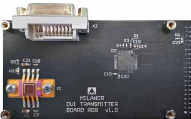
**Рис. 4.** Модуль-переходник для демонстрационных плат микросхемы 1986BC018
