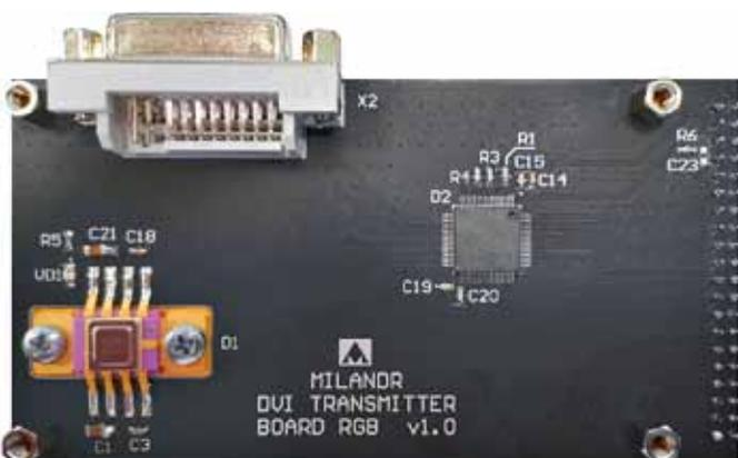
**Рис. 4.** Модуль-переходник для демонстрационных плат микросхемы 1986BC018
