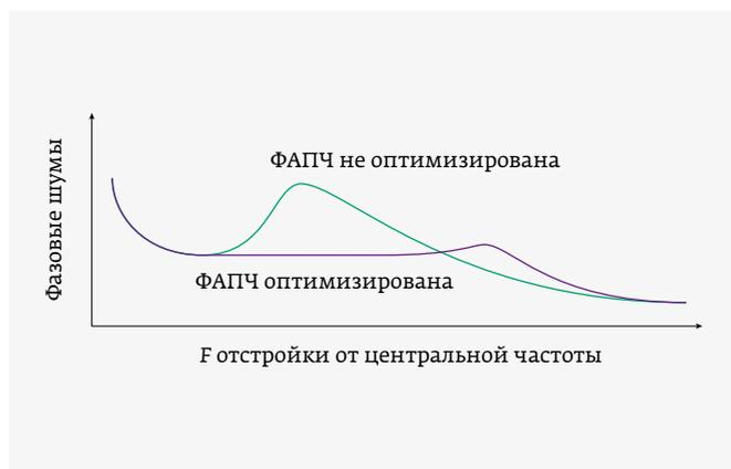
Рис. 3. Неоптимизированная и оптимизированная по шумам ФАПЧ
