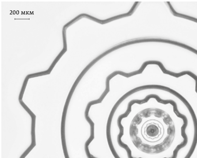
Рис. 5. MLE™ экспонирование фоторезиста SU-8 толщиной 600 мкм. Источник: https://www.evgroup.com
