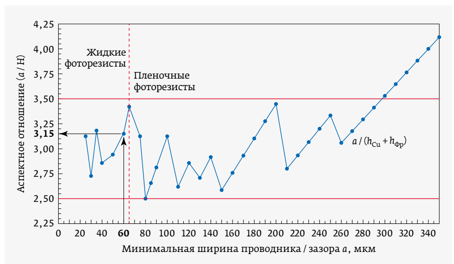
Рис. 5. График для определения аспектного отношения – отношения ширины канала a (зазора между проводниками при травлении) к его глубине H . Красные горизонтальные линии – верхнее и нижнее значение a/H в соответствии с неравенством (1)
