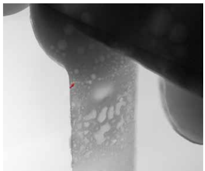
Рис. 14. Рентгеновский снимок микротрещины в области перехода печатной дорожки в контактную площадку
