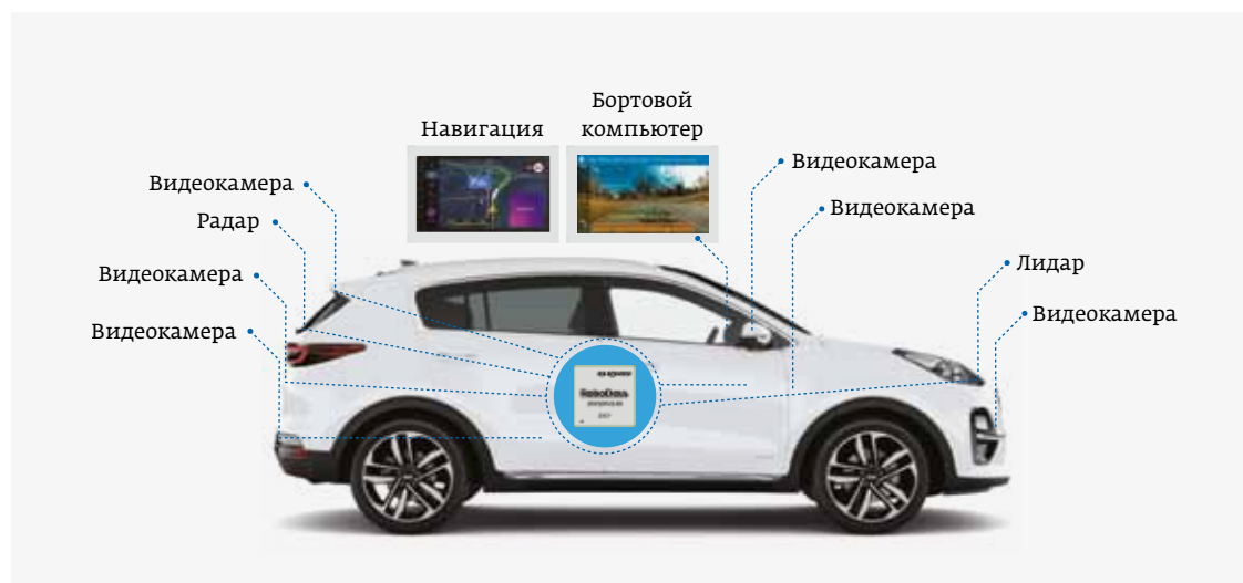
Рис. 11. Применение RoboDeus для управления сенсорами и устройствами умного автомобиля
