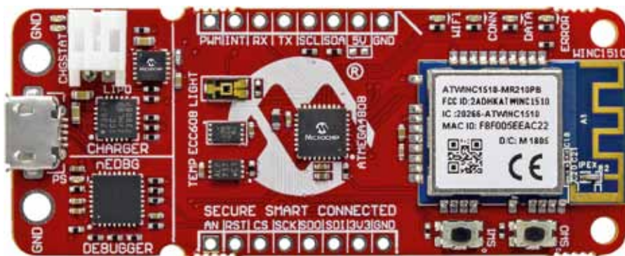
Рис. 4. Плата AVR-IoT WG Development Board сочетает в себе микроконтроллер AVR®, микросхему модуля обеспечения безопасности и сертифицированный сетевой Wi-Fi-контроллер, что позволяет разработчикам создавать прототипы подключенных устройств за считанные минуты
