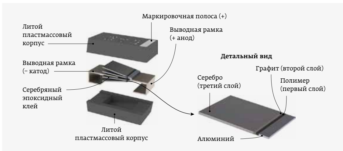
Рис. 5. Конструкция алюминиево-полимерного конденсатора в пластиковом SMD-корпусе серии A700
