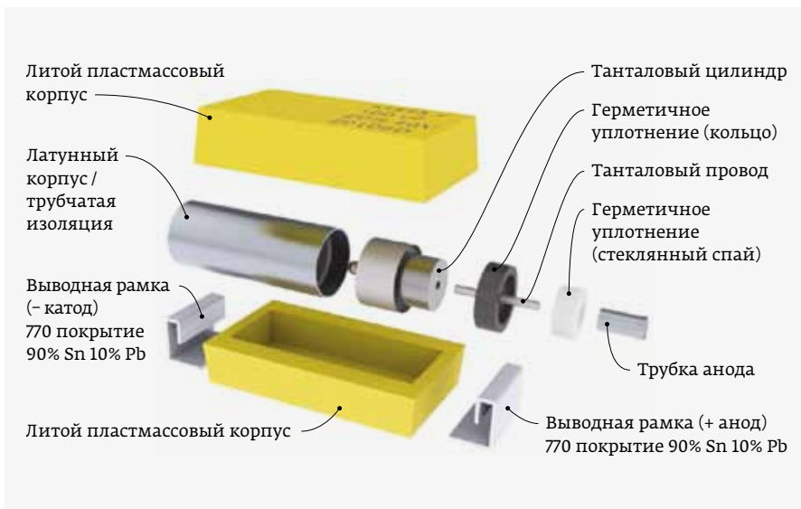
Рис. 3. Конструкция герметичных танталовых SMD-конденсаторов серии T555
