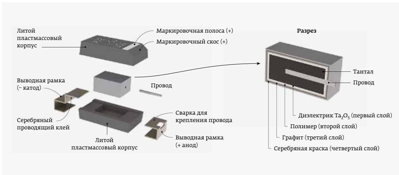
Рис. 1. Конструкция танталового полимерного SMD-конденсатора серий T591/T598/T599
