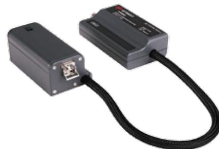
N7005A обеспечивают низкий уровень шума в ходе оптических измерений с модуляцией PAM4 при скорости передачи данных до 56 Гбод. Полный набор функций отладки позволит инженерам-разработчикам эффективно устранять неисправности в работе оптических устройств. Измеренные частотные характеристики применяются для оптимизации работы корректирующего фильтра во всех преобразователях N7005A. Эти данные необходимы для выравнивания кривой частотных характеристик с целью повышения точности измерений.
