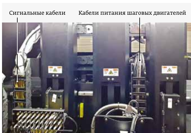
Рис. 5. Пример раздельной прокладки линий питания двигателей и сигнальной линии
