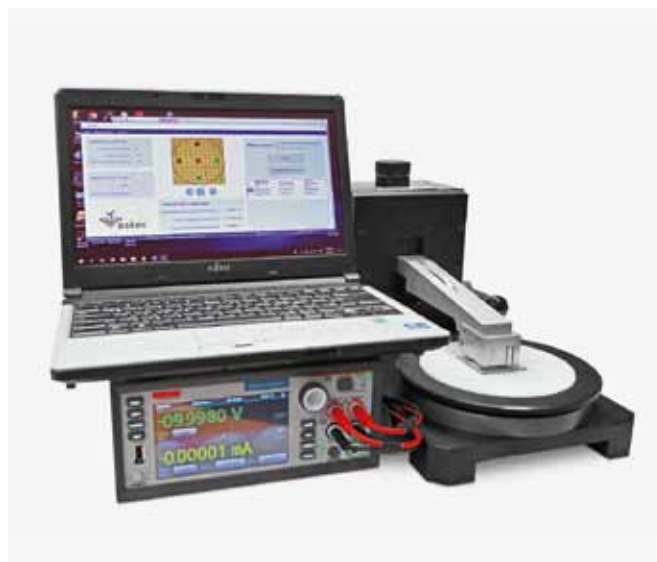
Рис. 8. Четырехзондовая установка для измерения удельного и поверхностного сопротивлений ИУС-7
