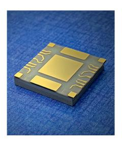
дачей входного напряжения на приборы спутника. Кристаллы расположены на подложке из нитрида алюминия с заращенными переходными отверстиями и соединены между собой по последовательно-параллельной схеме. Такое соединение позволяет гарантированно коммутировать напряжение даже в случае выхода из строя нескольких ключей в результате внешних воздействий и деградации компонентов. Это обеспечивает наивысший уровень отказоустойчивости.
