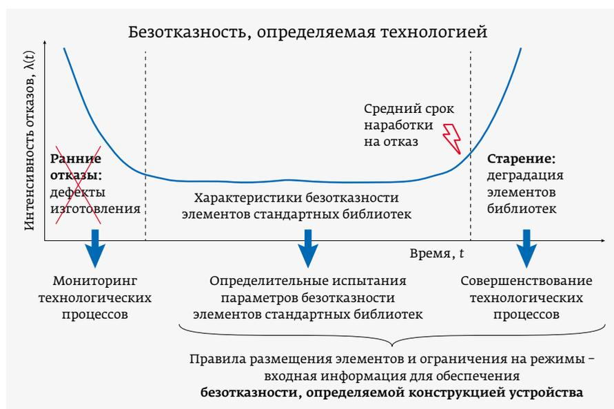
Рис. 1. Схема обеспечения параметров надежности библиотек стандартных элементов на уровне фабрики foundry
