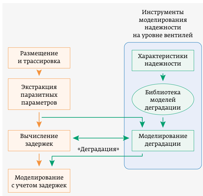
Рис. 2. Анализ надежности на уровне вентилях при проектировании цифровых БИС
