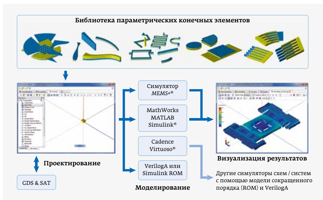
Рис. 2. Проектирование на основе библиотеки Coventor MEMS+
