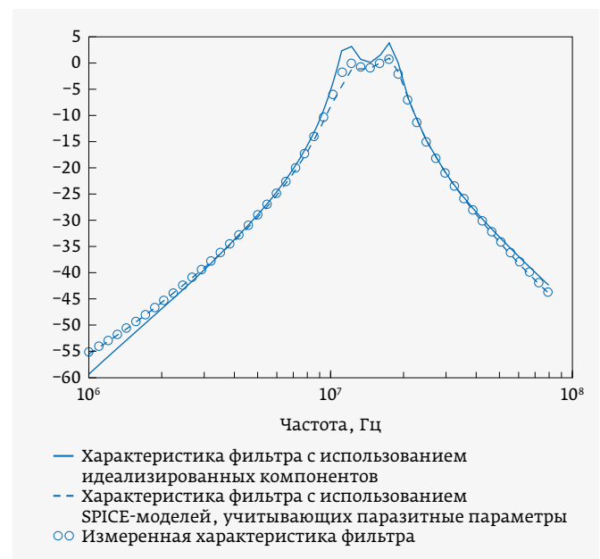
Рис. 15. Сравнение результатов моделирования и измерения передаточной характеристики полосового фильтра
