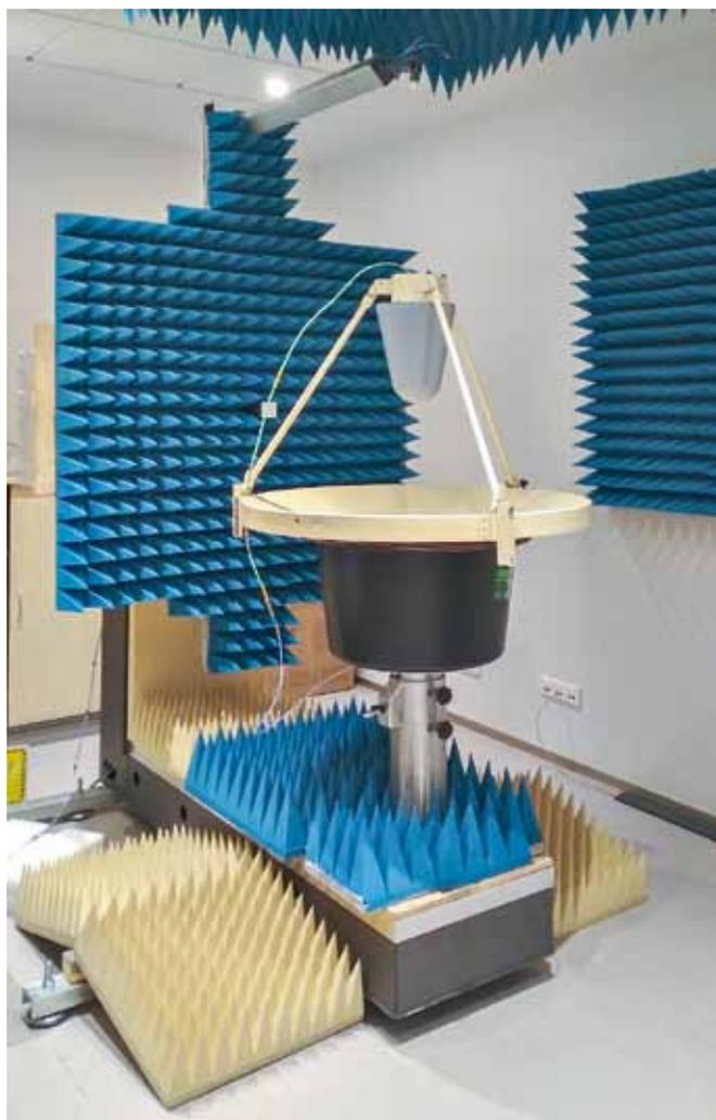
Рис. 1. Измерительный комплекс TS8991
