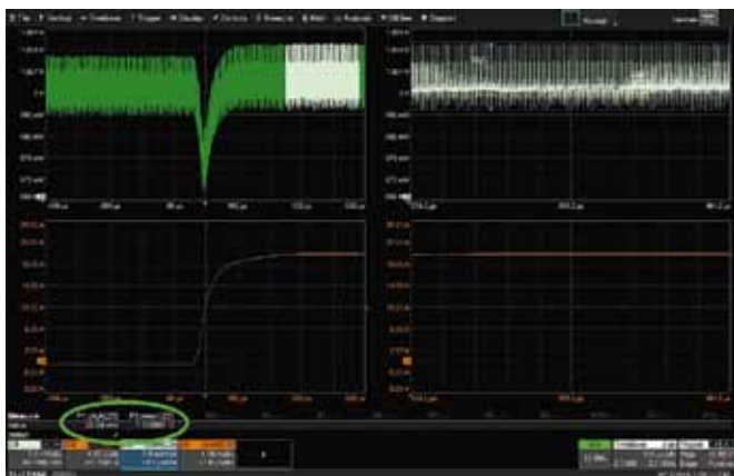
Рис. 8. Функция «Растяжка»: измерение уровня пульсаций (пик-пик) и среднего напряжения (этап после подключения нагрузки)
