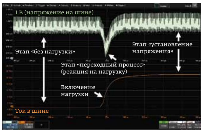
Рис. 2. Три этапа переходных процессов (откликов ИУ) при измерении пульсаций
