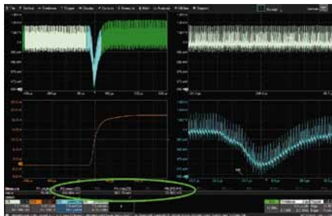
Рис. 9. Использование параметров в области увеличения для анализа различий между тремя состояниями ИУ
