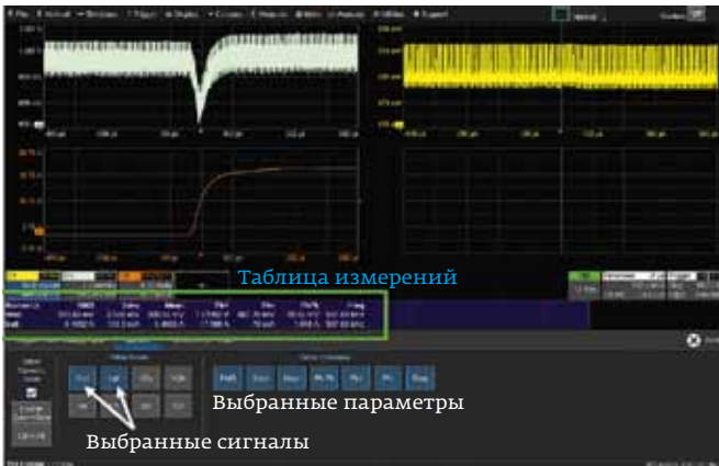
Рис. 11. Все значения параметров для анализа переходных процессов на шине электропитания вычисляются автоматически
