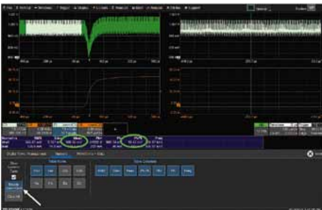
Рис. 12. Один клик на «Enable Zoom+Gate» обеспечивает растяжку и синхронизацию кривых и привязывает все измерения к одной и той же области масштабирования
