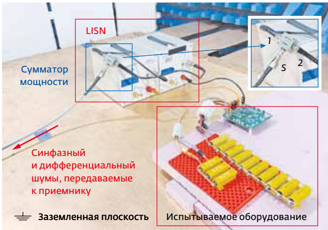
Рис. 4. Стенд для измерения синфазного и дифференциального шумов
