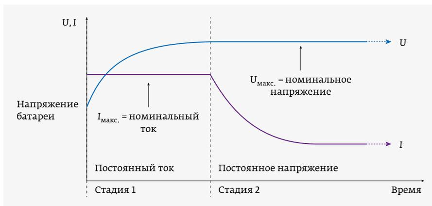
Рис. 2. График двухступенчатой зарядки
