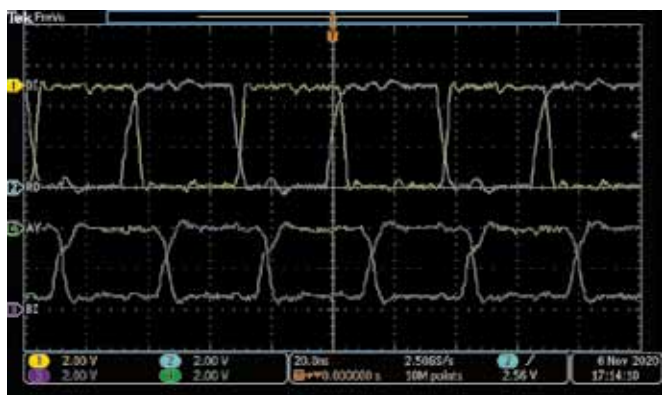
Рис. 12. Осциллограмма на выходе передатчика (данные с осциллографа Tektronix MDO3104): DI – информационный входной сигнал передатчика, AY, BZ – выходные сигналы передатчика, RO – выходной сигнал приемника
