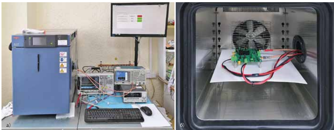
Рис. 11. Испытательная камера тепла и холода: а – вид снаружи; б – вид внутри
