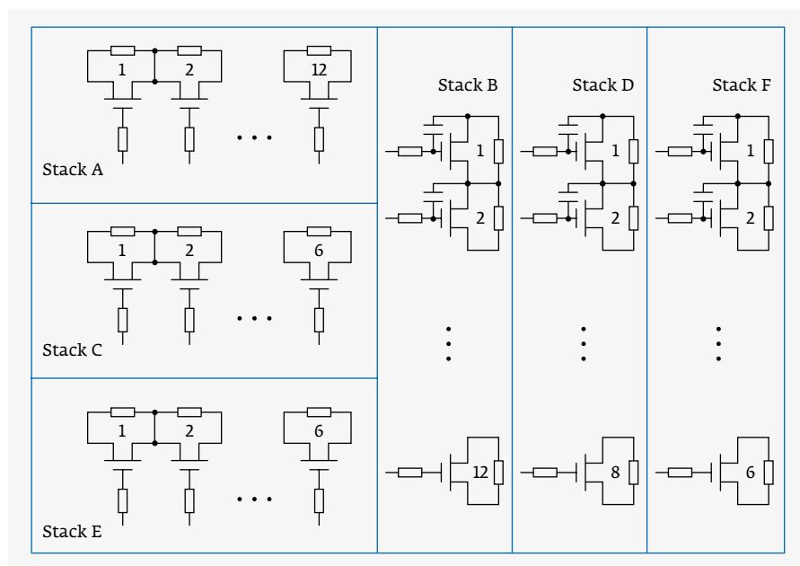
**Рис. 34.** Группы полевых транзисторов (stack), используемые в схеме переключателя, показанного на рис. 33
