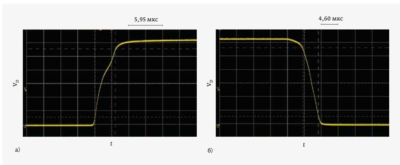
**Рис. 41.** Осциллограммы напряжений на выходе pin-диодного SPDT-переключателя P2T-500M40G-USB (компания PMI), управляемого по USB-интерфейсу, при включении (а) и выключении (б) одного из каналов
