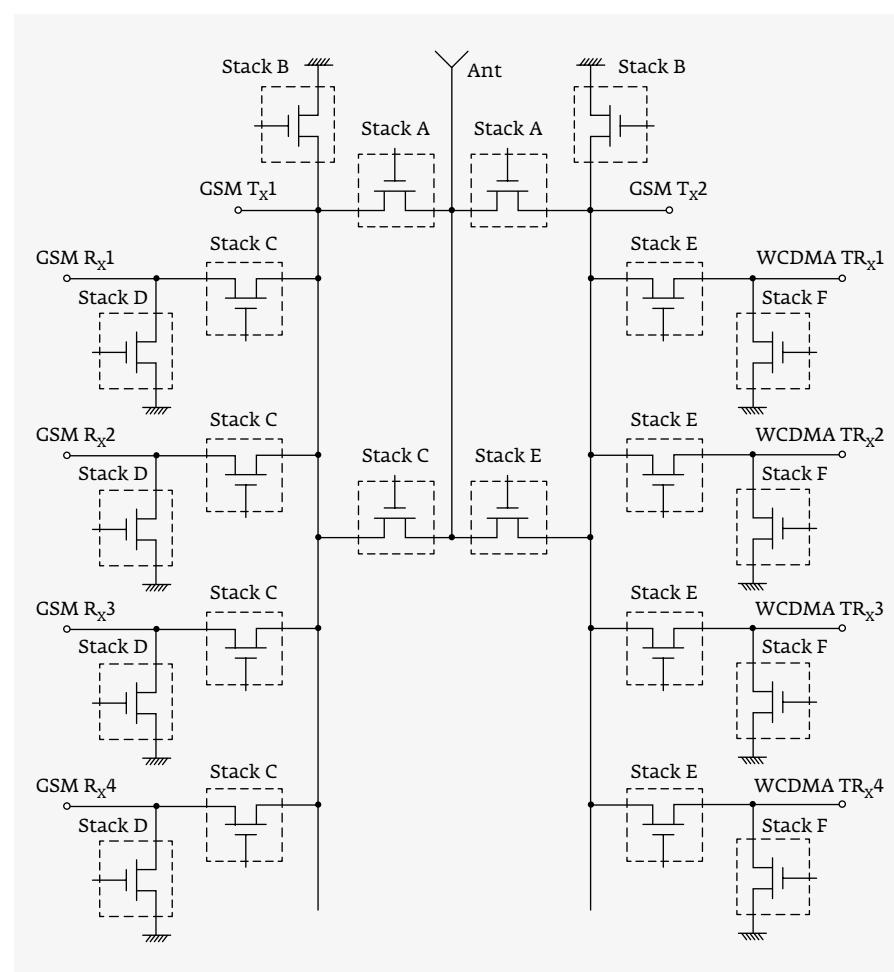
**Рис. 33.** Упрощенная схема антенного SP10T-переключателя, выполненного по КНИ КМОП технологии
