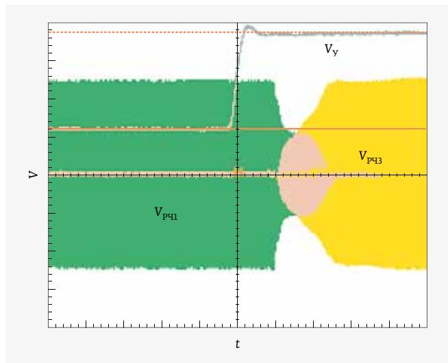
Рис. 37. Управляющий  $V_y$  и радиочастотные  $V_{pch1}$ ,  $V_{pch3}$  на 1-м и 3-м выходах сигналы SP4T-переключателя ADC904 компании Analog Devices при коммутации с 1-го на 3-й канал
