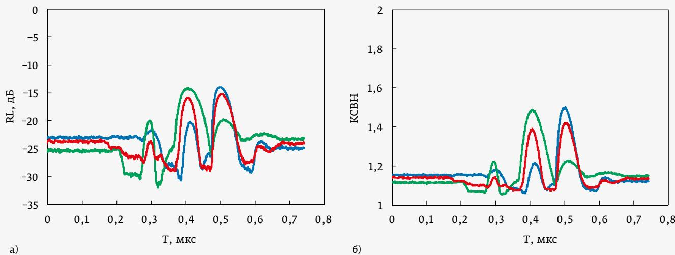
**Рис. 40.** Переходные процессы RL (а) и КСВН (б), возникающие на  $RF_1$ ,  $RF_2$  и  $RF_c$  портах SPDT-переключателя F2923 во время его коммутации: синий цвет – порт  $RF_1$  (переключение с  $RF_1$  на  $RF_c$  или порт  $RF_2$  (переключение с  $RF_2$  на  $RF_c$ ); зеленый цвет – порт  $RF_1$  (переключение с  $RF_c$  на  $RF_1$ ) или порт  $RF_2$  (переключение с  $RF_c$  на  $RF_2$ ); красный цвет – порт  $RF_c$  (переключение с  $RF_1$  на  $RF_2$  или с  $RF_2$  на  $RF_1$ )
