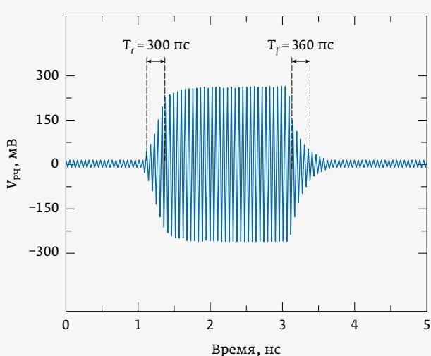
**Рис. 35.** Моделирование процесса формирования радиоимпульса на частоте 20 ГГц в SP4T-переключателе, выполненном по стандартной (IBM8HP) КМОП-технологии
