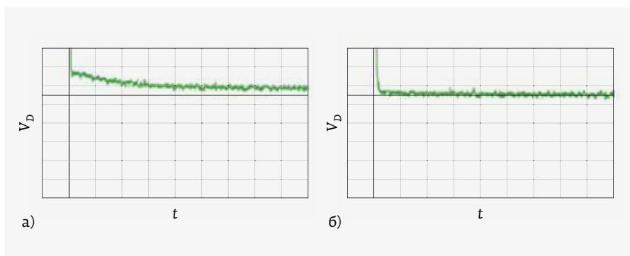
**Рис. 39.** Процессы установления стационарного режима в двух переключателях компании Analog Devices: а – модель HMC540, GaAs PHEMT технология; б – модель HMC540S, кремниевая КМОП-технология
