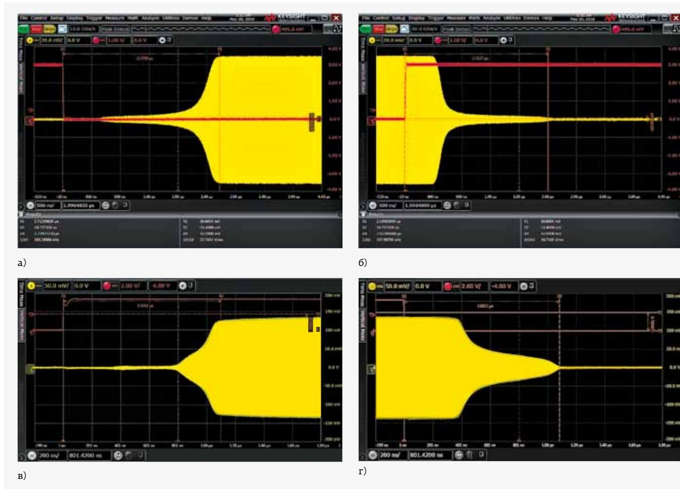
Рис. 36. Осциллографмы напряжений на выходе SPDT-переключателей компании IDT при переходе из закрытого состояния в открытое (а, в) и из открытого состояния в закрытое (б, г): а, б – модель F2970; в, г – модель F2977
