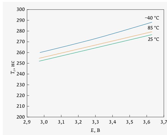
Рис. 38. Изменение времени нарастания  $T_r$  в зависимости от напряжения питания  $E$  при различных температурах окружающей среды
