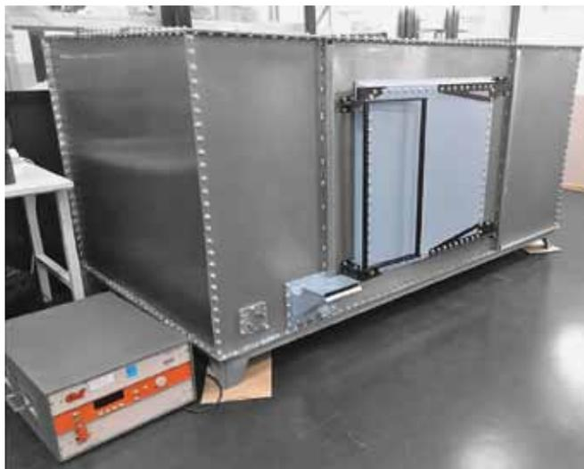
Рис. 1. Реверберационная камера лаборатории ЭМС АО «ТЕСТПРИБОР»
