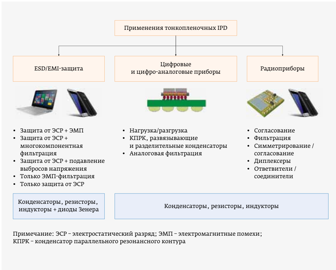
Рис. 1. Основные применения тонкопленочных IPD
