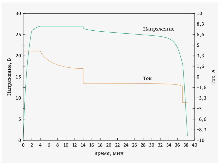
Рис. 1. График кривой заряда-разряда ионистора
