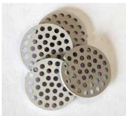
Рис. 3. Заготовки дисковых массивов до обжига
