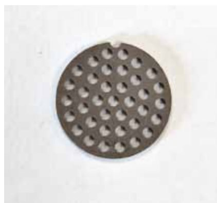
Рис. 4. Заготовка дискового массива после обжига
