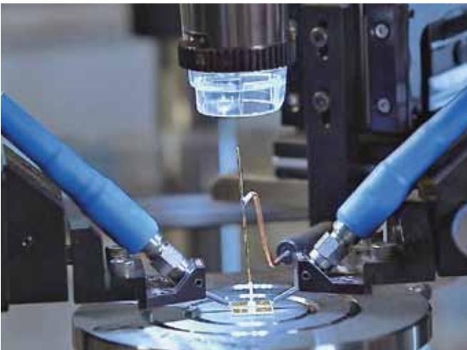
Рис. 1. Зондовая измерительная станция
