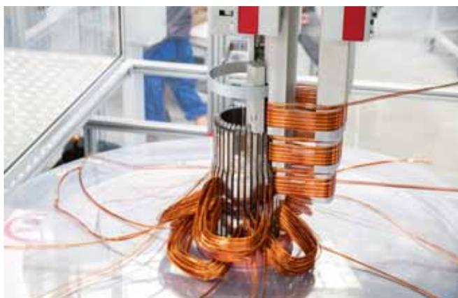
**Рис. 8.** Намотка катушечных групп прецизионной пряжей, включающей более 12 параллельных проводов
