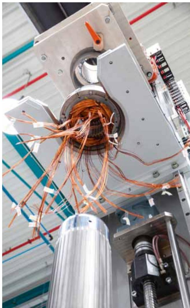
**Рис. 10.** Предварительная формовка с монтажом закрывающих паз клиньев
