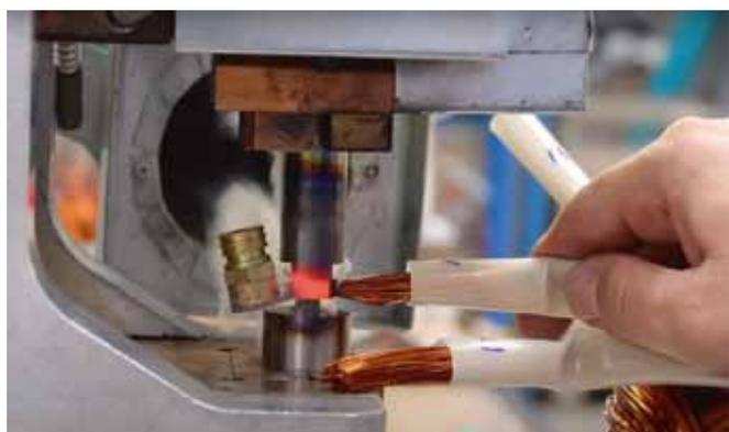
Рис. 13. Горячее прессование наконечника без предварительной зачистки проводов существенно экономит время процесса
