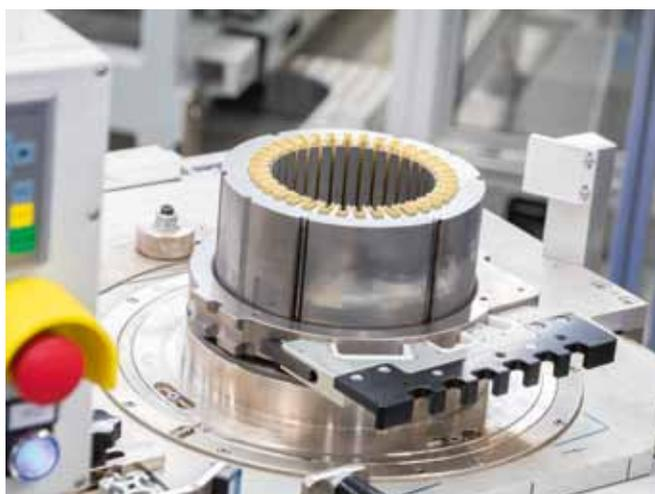
**Рис. 7.** Статор с изолированными пазами
