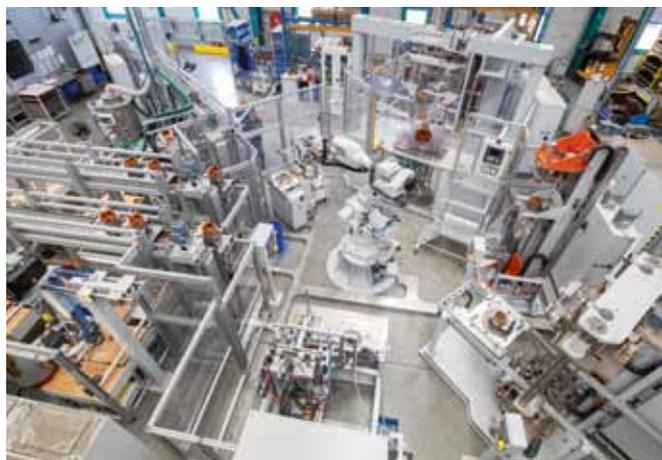
**Рис. 2.** Общий вид автоматизированной линии изготовления статоров
