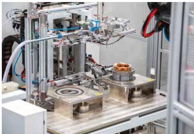
Рис. 18. Станок для осуществления синхронного бандажа лобовых частей с двух сторон
