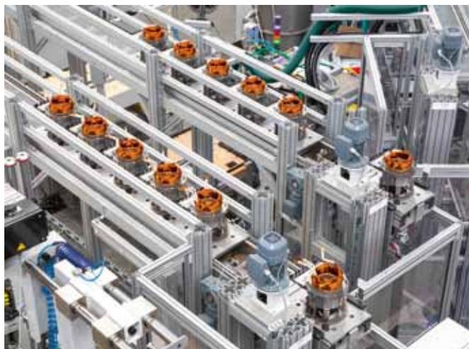
Рис. 14. Система конвейеров для зоны ручных операций
