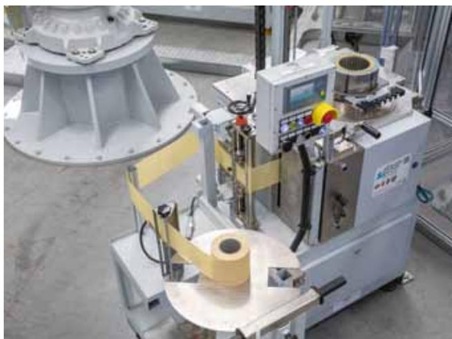
**Рис. 6.** Общий вид станка для монтажа пазовой изоляции
