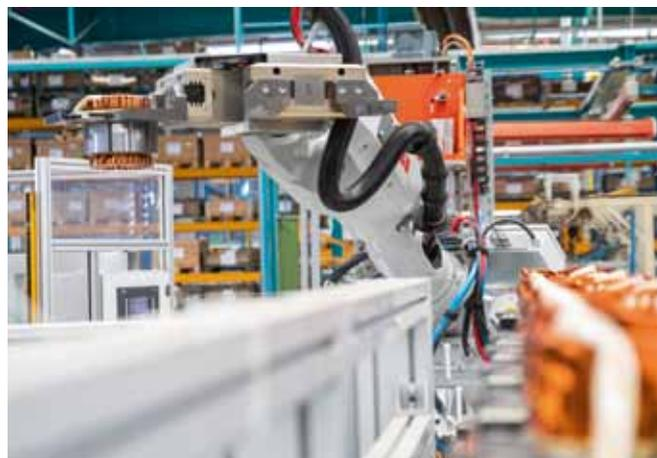
Рис. 20. «Сердцем» линии является робот-манипулятор АВВ, вокруг которого построена вся система
