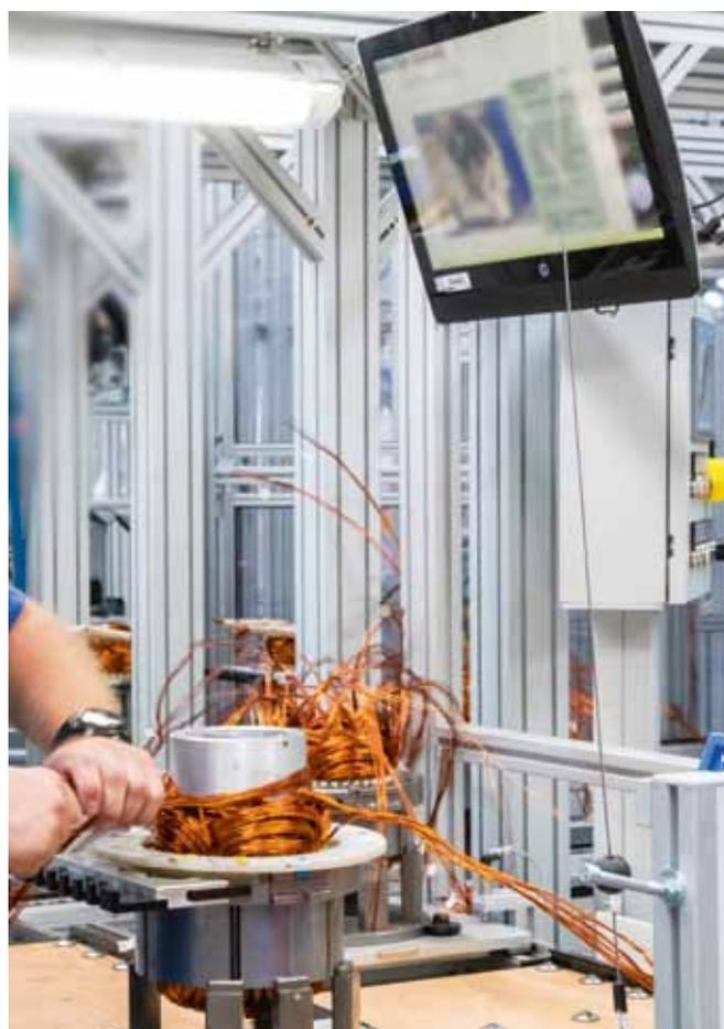
**Рис. 3.** При производстве последовательности статоров различных типоразмеров планировщики задач значительно облегчают работу операторам своими непрерывными подсказками
