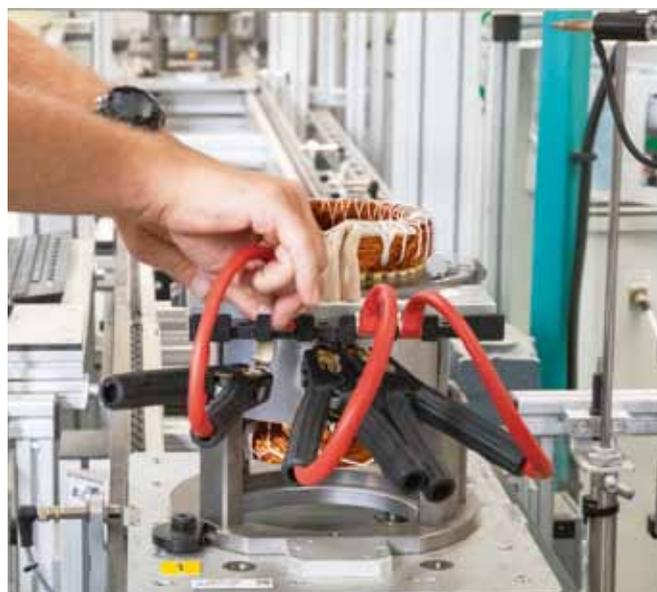
Рис. 19. По окончании электрического теста оператор демонтирует всю оснастку и передает готовый статор на упаковку
