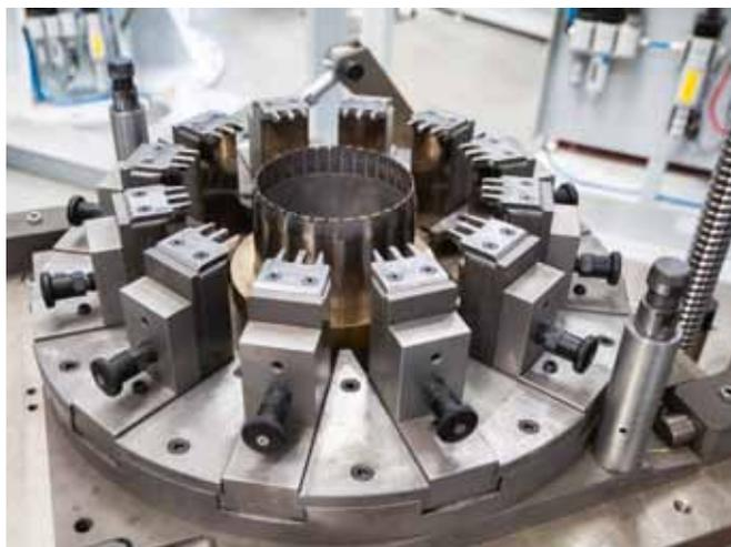
Рис. 16. Оснастка нижней части формовочного станка
