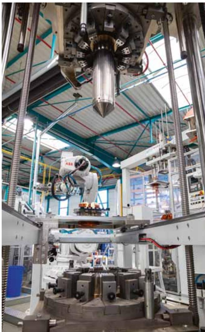
Рис. 15. Формовка лобовых частей статора с подготовкой отверстий для последующего бандаж
