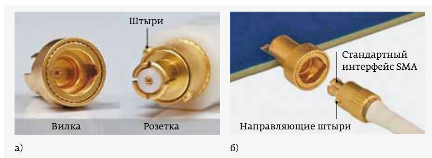
Рис. 4. Вилка и розетка соединителей SMP-L (а) и их соединение (б)
