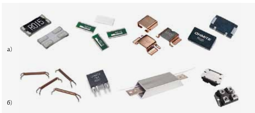
Рис. 39. Токоизмерительные резисторы компании Ohmite: а — серии резисторов для поверхностного монтажа, рассчитанных на мощности до единиц ватт; б — серии выводных резисторов, рассчитанных на разные мощности и токи до 300 А
