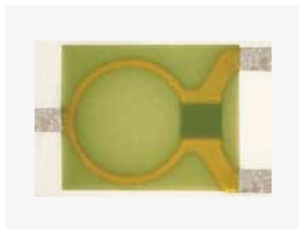
Рис. 29. Делитель Вилкинсона (работающий на частотах до 6 ГГц) в чип-корпусе (компания IMS)
